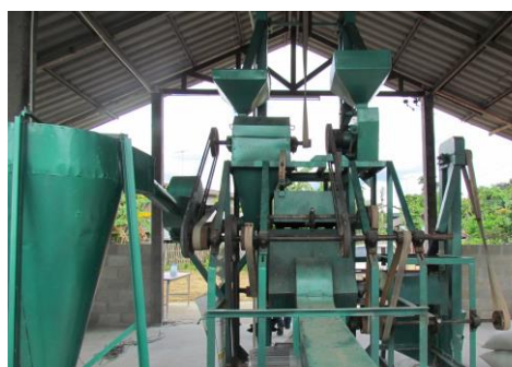
ภาพที่ 3 ตำแหน่งติดตั้งมอเตอร์และการปรับความตึงสายพาน
