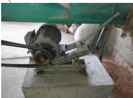
ภาพที่ 3 ตำแหน่งติดตั้งมอเตอร์และการปรับความตึงสายพาน
